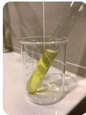
3. 取20ml赤血鹽 ( $K_3Fe(CN)_6$ ) 溶液於試管中。
