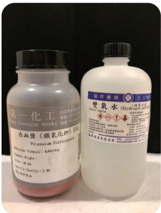
2. 取0.3 g的赤血鹽 ( $K_3Fe(CN)_6$ ) 溶解於50 mL的蒸餾水中，然後再加入1 mL的3%雙氧水，再將其稀釋為100 mL而成。此溶液為赤血鹽 ( $K_3Fe(CN)_6$ ) 溶液。模擬血液裡血紅素含有的鐵離子。
