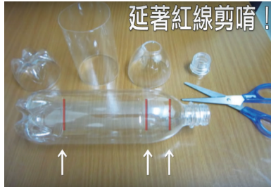
Step 2 剪出製作水火箭的各結構
