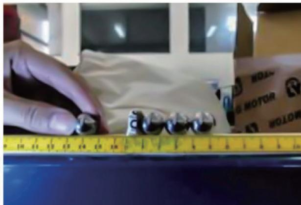
數個一樣的鋼球吸在強磁的一側 (如右上照片的右側) · 由磁鐵的另外一側以另一個鋼球向他們滾動最終球碰撞。右側一串鋼球最右側球會以驚人的高速度彈出。改變磁鐵與鋼球的位置、數量，探討這些因素對右側鋼球射出速度的影響，如何達到最佳效果 (射出速度)。並請嘗試建立理論模型去解釋你的實驗結果。
