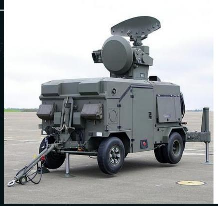
天兵雷達車的 天線上方為搜 索雷達,下方 圓盤為射控雷 達・可控制兩 座雙 連 裝 35mm 快 砲 及一座麻雀飛 彈組而成為機 場防禦系統。
